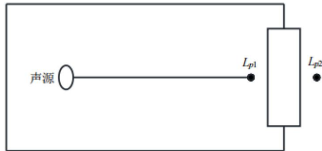
图 4-1 室内声源等效为室外声源图例
