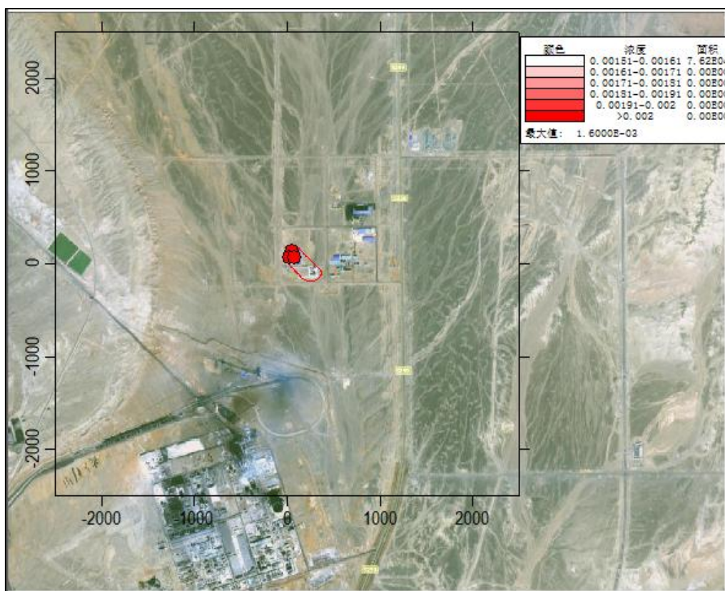
图 5.2-35 Cd 最大年均预测浓度等值线图 单位: \mu\text{g}/\text{m}^3
