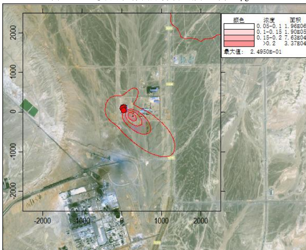
图 5.2-24 NO 2 最大年均贡献浓度等值线图 单位: \mu\text{g}/\text{m}^3
