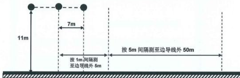
图 2 220kV 阜东寨一线电磁断面监测示意图
