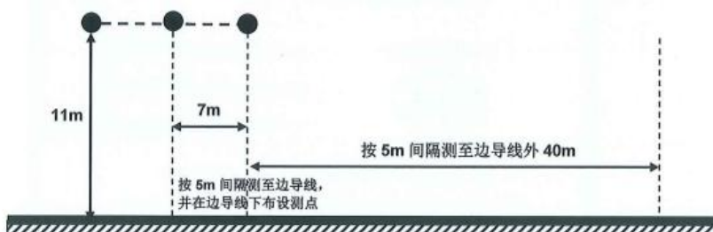
图 3 220kV 阜东寨一线噪声断面监测示意图
