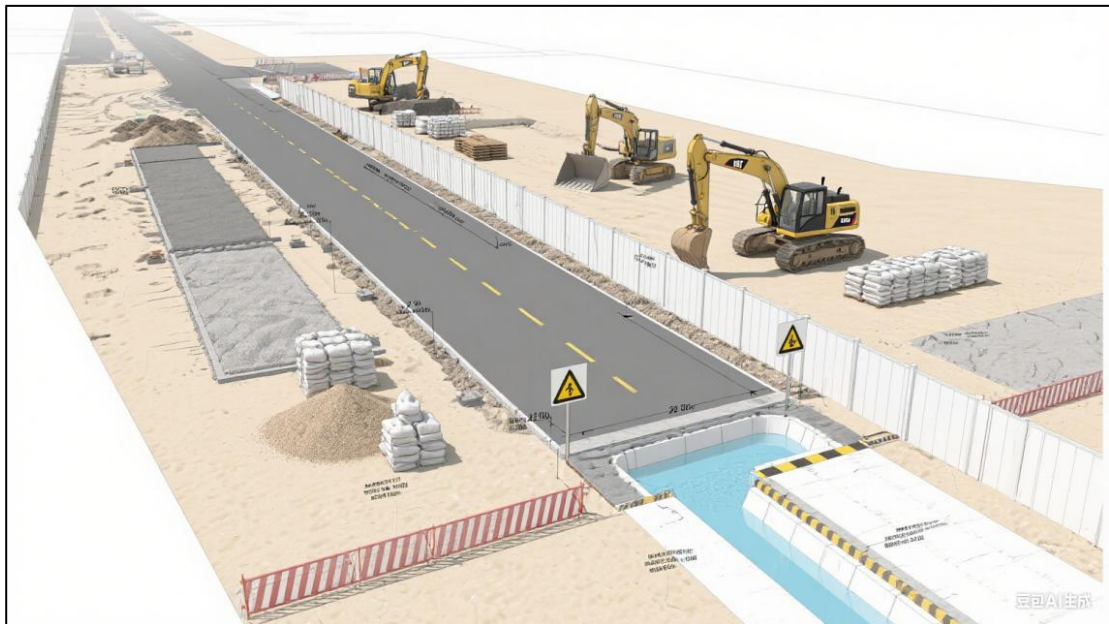
图 2-1 永临结合施工布置图
