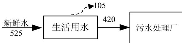
图 2-1 项目水平衡图 (m<sup>3</sup>/a)
