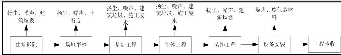
图 2-2 施工期工艺流程及产污环节
