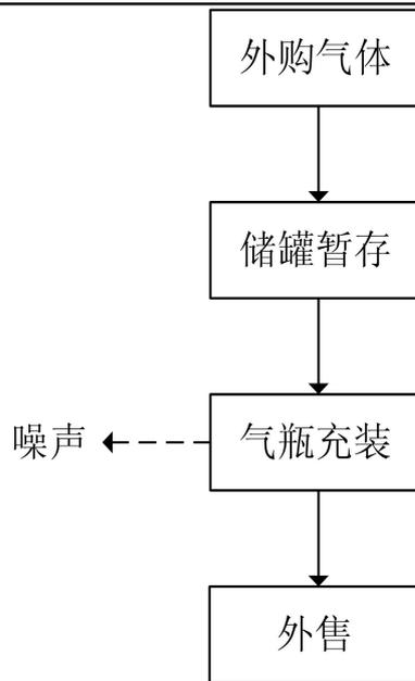
图 2-3 生产工艺流程及产污环节分析
