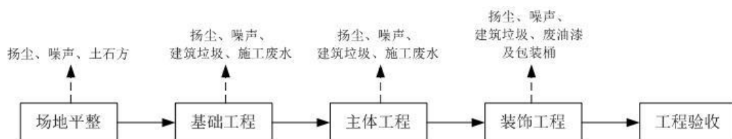
图 2-1 施工期工艺流程及产污环节分析
